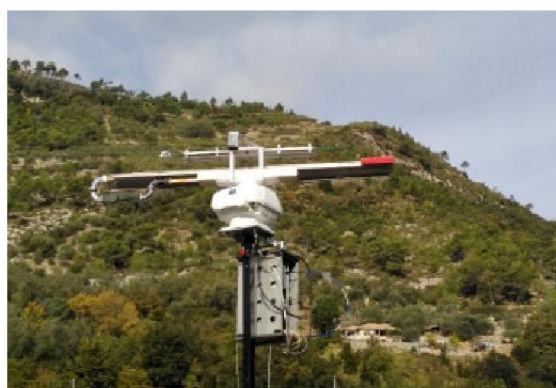
Fig. 5 - Il radar armonico per il tracciamento del volo dei calabroni
