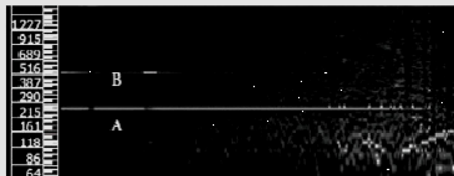
Fig. 2.4 – Spettrogramma sonoro di una nota di Do ottenuto pizzicando una corda di chitarra.
