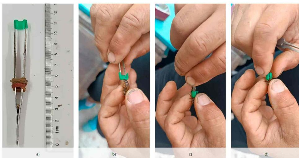
*Figura 4. Las pinzas de laboratorio modificadas (a) con las puntas ligeramente arqueadas hacia fuera se utilizaron para montar el anillo (b y c). La maniobra de rotación (d) para comprobar la colocación del anillo y el aflojamiento necesario.*
