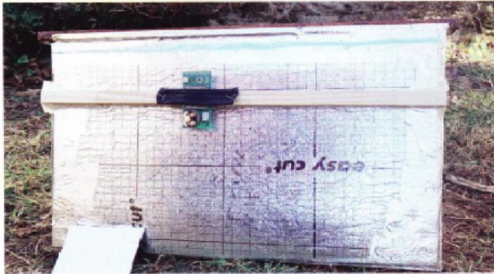
**Figura 7.** Telaio in legno ricoperto di Easy cut. Il ritaglio mostra il polistirolo che costituisce il retro della superficie riflettente
