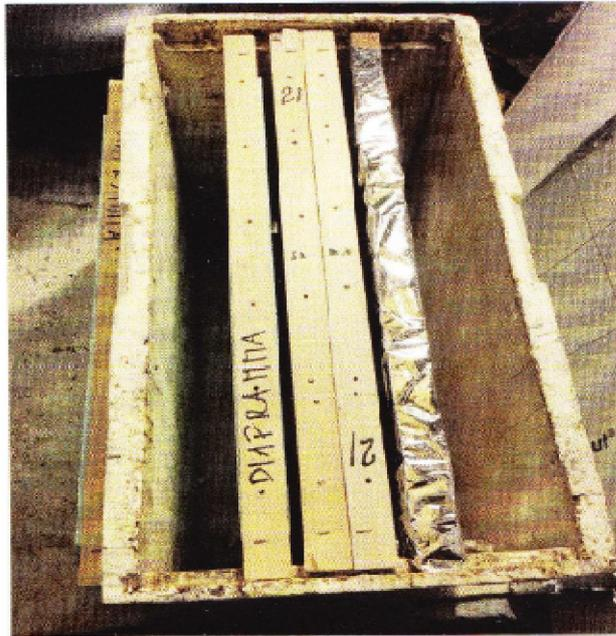
**Figura 4.** L'arnietta di polistirene in cui sono state effettuate le misurazioni. Al centro i due telaini in mezzo ai quali c'è il riscaldamento con i suoi due Data Logger, sui lati ci sono i due diaframmi, sul lato esterno dei quali sono fissati due altri sensori
