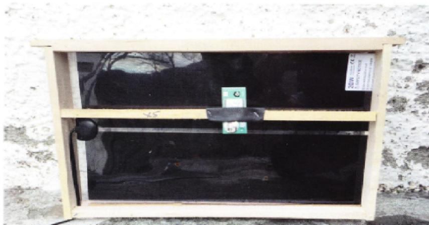
**Figura 3.** Il riscaldamento per terrari, montato tra due telaini; su entrambi i lati c'è un sostegno per il sensore di temperatura
